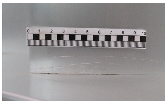
Figure 21 : CARACAS, Détail des éraflures en basse
