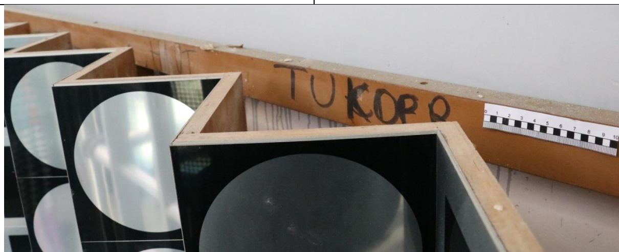
Figure 16 : TUKOER, Détail de l'âme en bois vue du dessus
