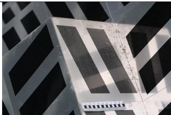
Figure 26 : PYR-DAC, Détail de la forte poussière sur la face supérieure
