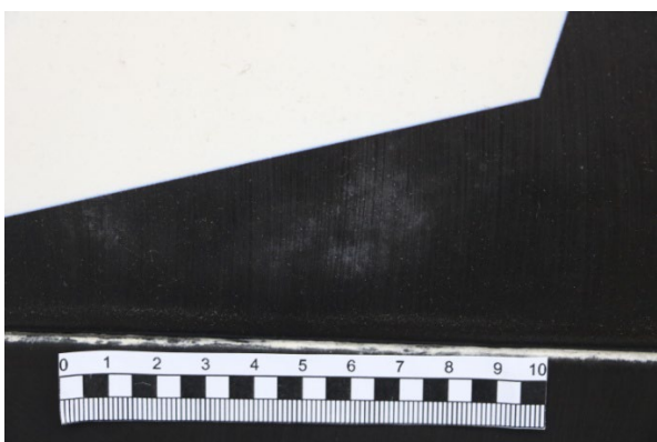
Figure 10 : TLINKO, détail, blanchissement localisé sur la couche noire d'un des carreaux.
